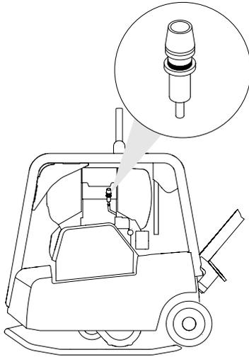
▶ Den Motor kurz auf Höchstdrehzahl bringen. Wenn sich dabei der Gummibalg zusammenzieht und das grüne Feld „2“ überdeckt, ist die Luftfilteranlage zu warten. Unter staubigen Bedingungen den Gummibalg mehrmals täglich kontrollieren.
